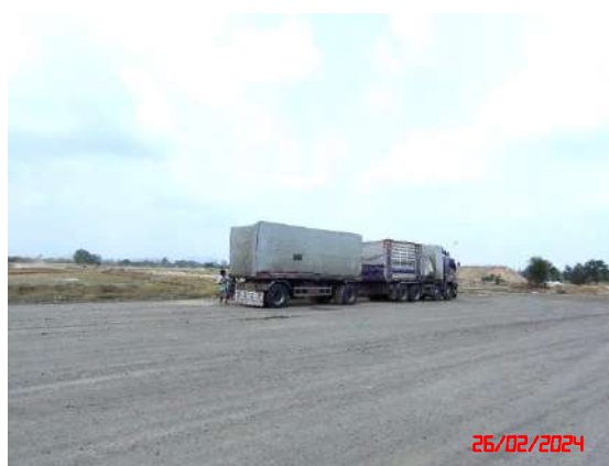
รูปที่ 18 การใช้ผ้าใบปิดคลุมรถบรรทุกแร่
